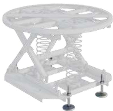
855 008 092 - Jeu de 4 pieds ajustables de 35 à 160 mm permettant de surélever la table pour mise à niveau sur sol inégal et faciliter la prise par un chariot élévateur
