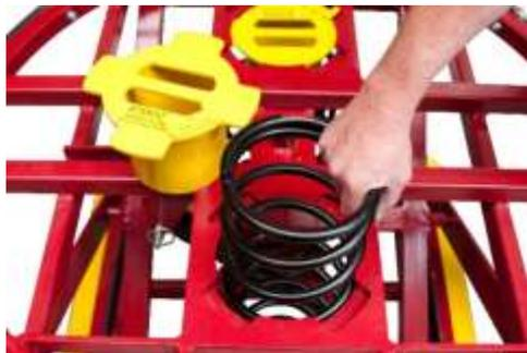
Mise en place des ressorts pour réglage des charges
