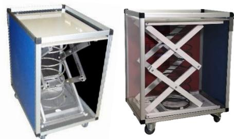
Détail du pantographe
