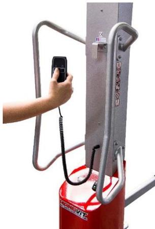
Poignées papillon permettant d'ajuster la position des mains à la taille de l'opérateur.
