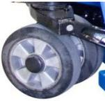
Roues caoutchouc montées sur axe oscillant pour réduire les efforts de roulage et assurer la stabilité de la charge transportée.
