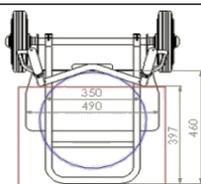
Tablier légèrement incurvé permettant le bon maintien de charges planes ou cylindriques.
